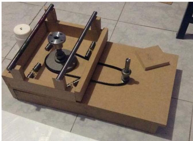
**Fig. 11. Montaje del sistema de transmisión.**
