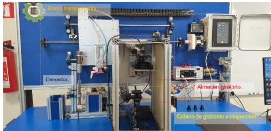
Figura 6 Implementación de la celda de grabado e inspección.
