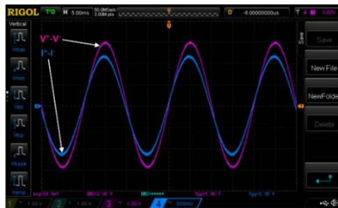
Figura 16 CH3: V+-V, 1 V/div, CH4: I+-I-, 500 mV/div.  $P_{entregada}$ : 1402,8 W.
