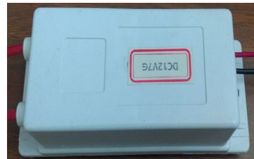
b) Modulo alta tensión del generador de Ozono
