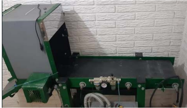
Figura 3 Prototipo con malla. Figura 4 Prototipo depurador de vidrio con banda negra.
