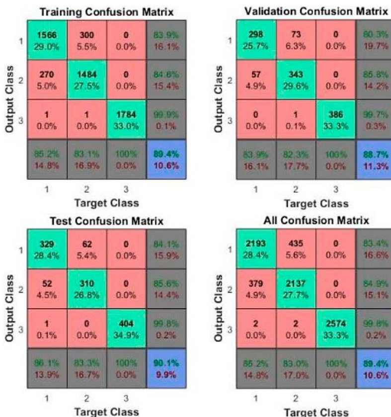
Figura 9 Matriz de confusión arquitectura de red de 40 neuronas en la capa oculta.
