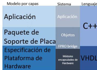
Figura 5 Implementación del sistema representado por capas.
