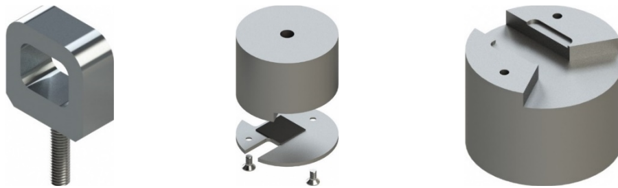
a) Herramienta para extracción. b) Vista isométrica explotada. c) Vista inferior de la cavidad para el flujo. Figura 3 Modelo renderizado del prototipo de porta muestras.
