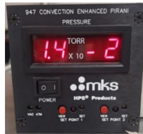
Figura 11 Medición del sensor de presión después de una hora de vacío.
