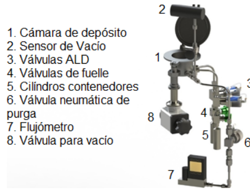
Figura 1 Modelo en SolidWorks de la red neumática.
