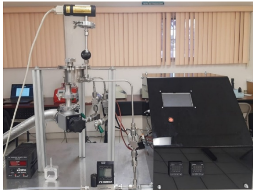
Figura 9 Estación del sistema ALD térmico terminada.
