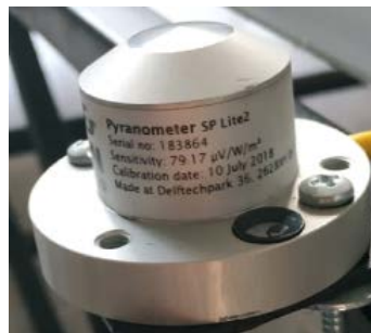
Figura 6 Foto propia del Piranómetro mostrando sus características.
