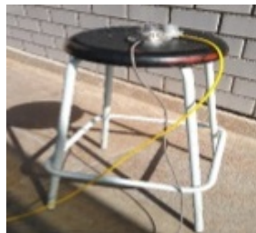
Figura 15 Calibración del piranómetro, utilizando otro de referencia.
