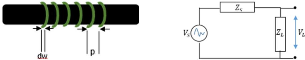
a) Distancias para cálculo de factor rosa. b) Circuito equivalente entre antena y electrónica
