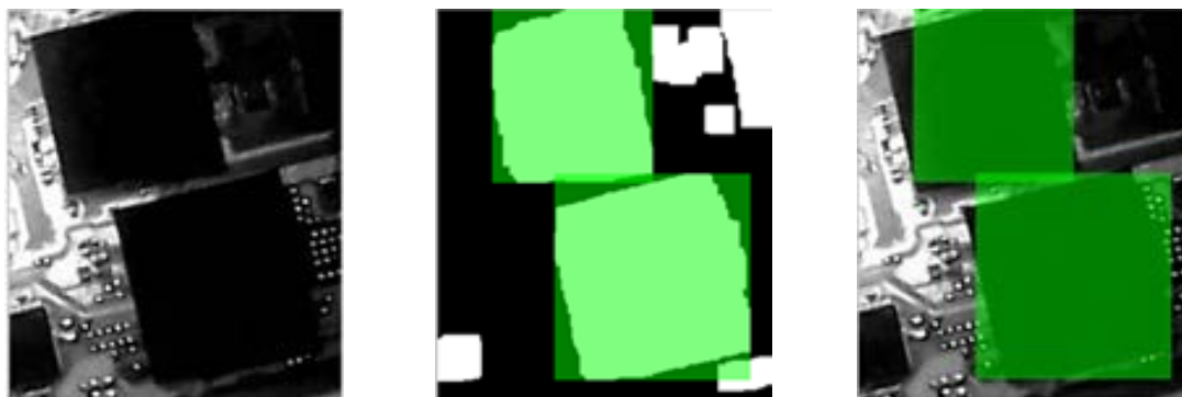
a) Circuito iluminación coaxial. b) Segmentación por reflectancia. c) Ubicación y conteo de SMT.
