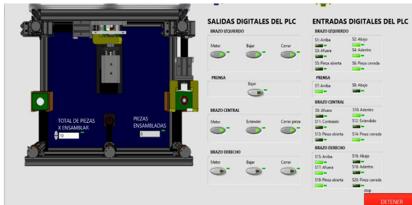
Figura 8 Estado de operación de la celda virtual controlada por el simulador del PLC.
