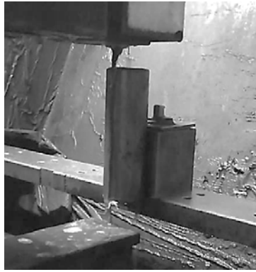
Figura 5 Corte por electroerosión de tubo.
