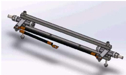
Figura 3 Dirección mecánica tipo Ackermann ubicada en la parte delantera del robot.
