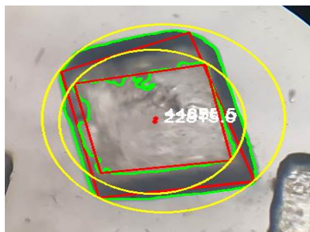
Figura 7 Detección de forma y mediciones de área del cristal.
