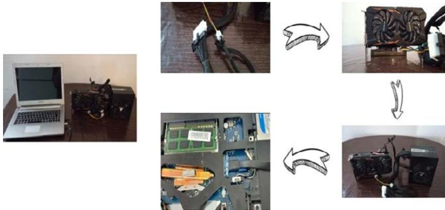
Figura 10 Montaje del adaptador EXP GDC.
