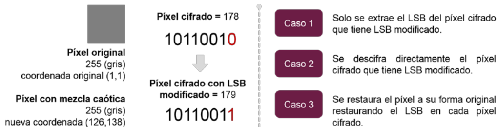
Figura 9 Ejemplo de modificación del LSB.
