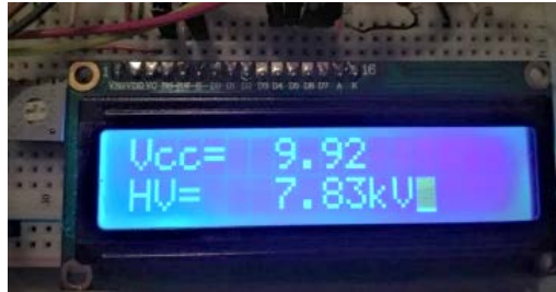
Figura 17 Despliegue de V_{CC} y la estimación del voltaje de salida.
