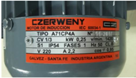
Figura 2 Características de carcasa del motor.
