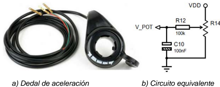
Figura 7 Ajuste de velocidad del motor.
