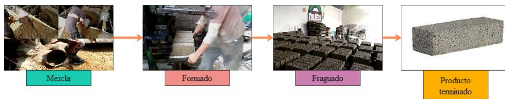
Figura 2 Proceso de fabricación de tabicón ligero.
