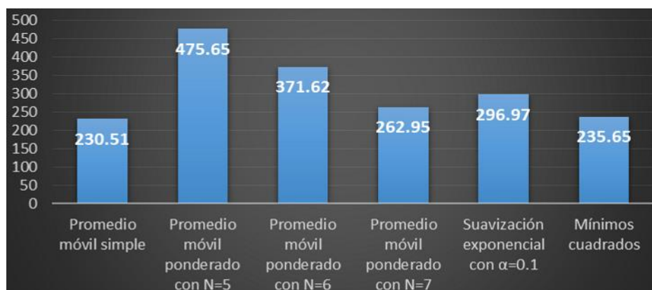
Figura 4 Comparación de error total al usar cada uno de los métodos de pronósticos.
