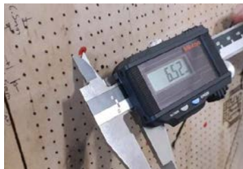
Figura 12 Medición de la distancia entre dos puntos de la matriz.
