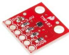
Figura 5 Sensor temperatura TMP102.
