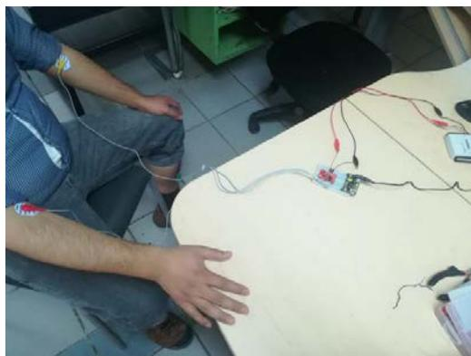
Figura 5 Toma de una señal ECG.
