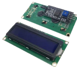
Figura 5 Liquid cristal display 16x2 con módulo I2c.
