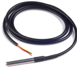
Figura 3 Sensor para uso a intemperie ds18b20.
