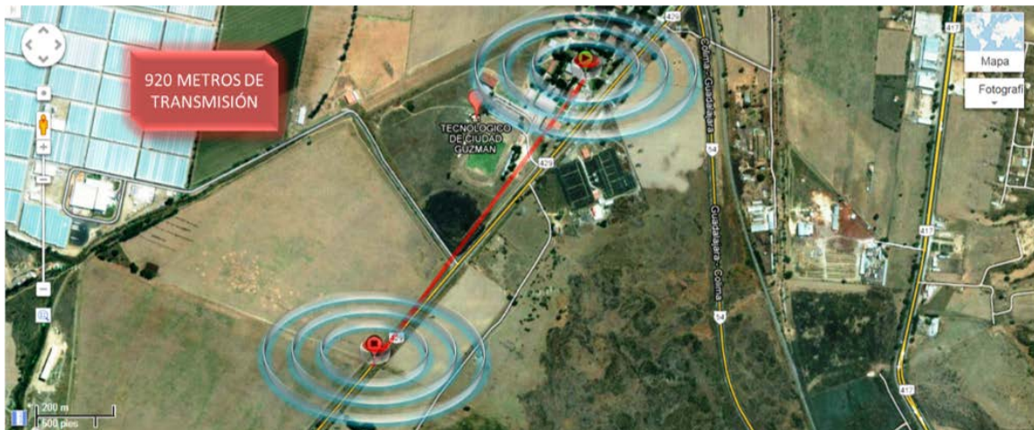
Figura 9 Vista satelital de la distancia de transmisión entre el laboratorio de electrónica del ITCG y la entrada de un Parque de Software ubicado a 920 m.
