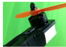
Figura 4 Motor EMAX 2204 montado en eje.
