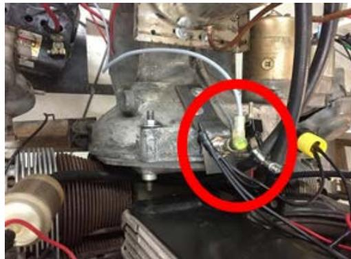
Figura 2 Termopar tipo K en tubo de escape (termistor).
