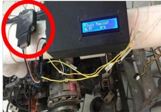
Figura 1 Sensor de flujo de aire MAF en válvula de admisión.
