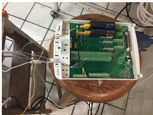
Figura 3 Bloque terminal SCC 68 para instalación de acondicionadores de señal.
