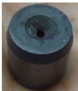
Figura 4 Dado de carburo de tungsteno [Alfope].
