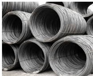
Figura 2 Materia prima necesaria para el proceso de trefilación [Alfope].
