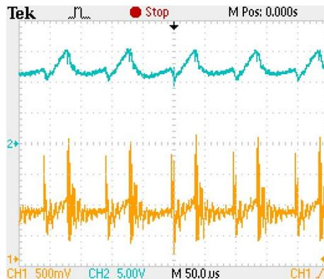
Figura 7 Formas de onda del voltaje y corriente de salida del convertidor CD-CD.
