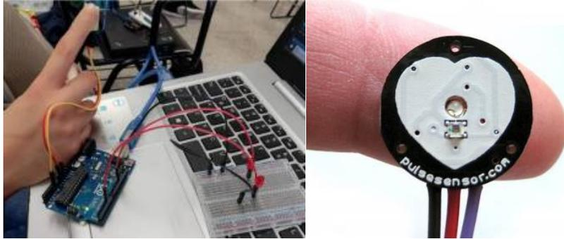
Figura 2 Adquisición de la señal de PPG.
