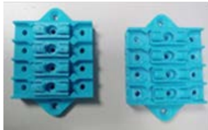
Figura 14 Producto final elaborado en manufactura aditiva en prototipado 3D.
