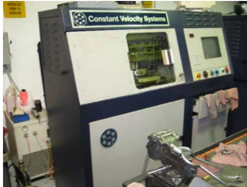
Figura 3 Equipo de rectificación (CVS Universal) a reconstruir.
