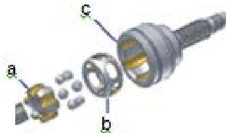
Figura 4 a) Estrella “Race”, b) Jaula “Cage” y c) Campana “Housing”.
