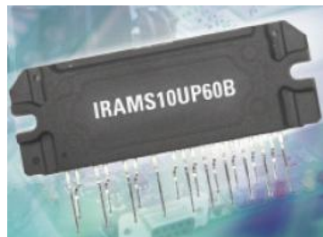
Figura 2 Módulo Inteligente de Potencia.
