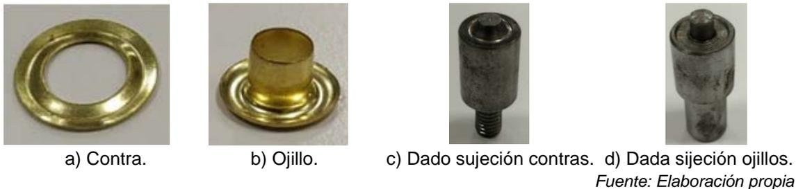
Figura 1 Herramental para remache y piezas fabricadas por este método.
