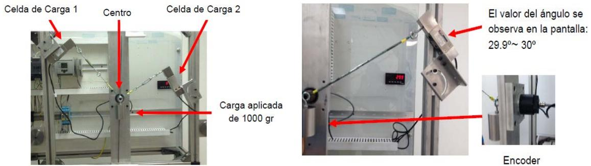
Figura 8 Preparación y puesta a punto de la carga y ángulos en la consola didáctica.
