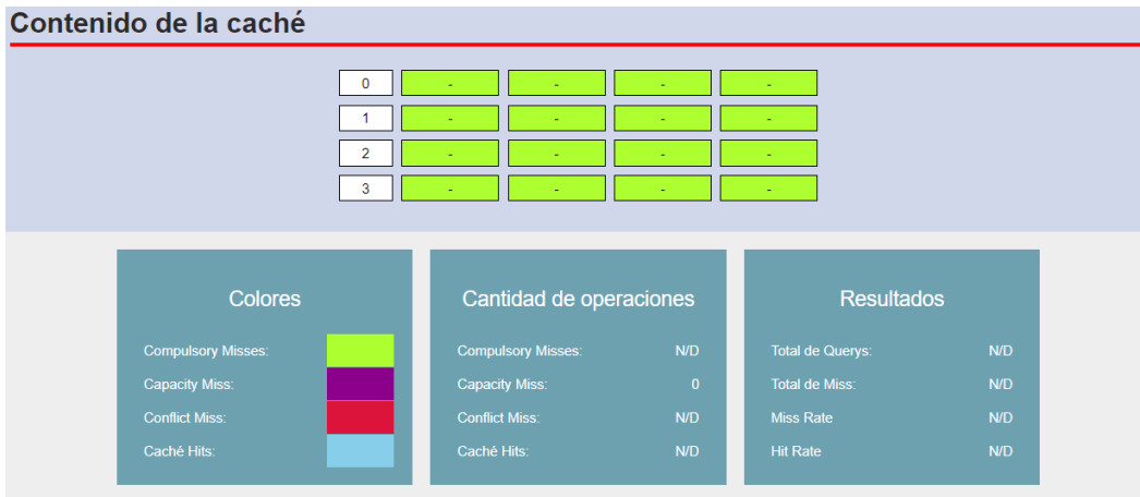
Figura 4 Simulación del contenido y operaciones de la memoria caché.
