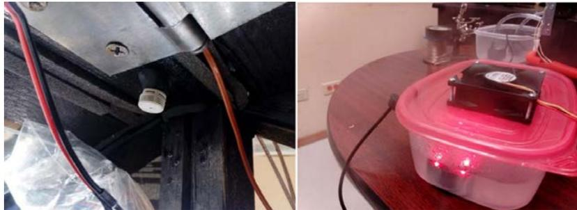
Figura 17 Sensores de humedad ambiental y Humificador del invernadero
