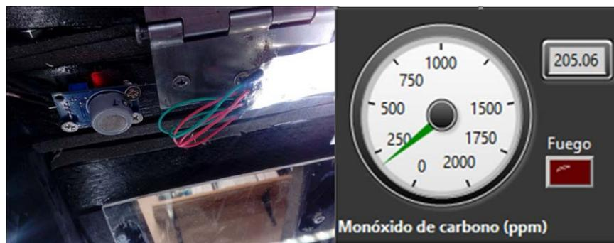
Figura 24 Sensor de monóxido de carbono en el techo del invernadero.
