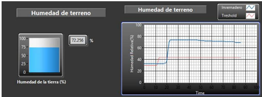
Figura 21 Humedad antes y después de accionarse el riego.
