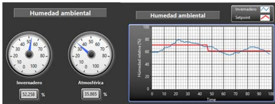
Figura 18 Indicadores de Humedad de la interfaz gráfica y respuesta del controlador.
