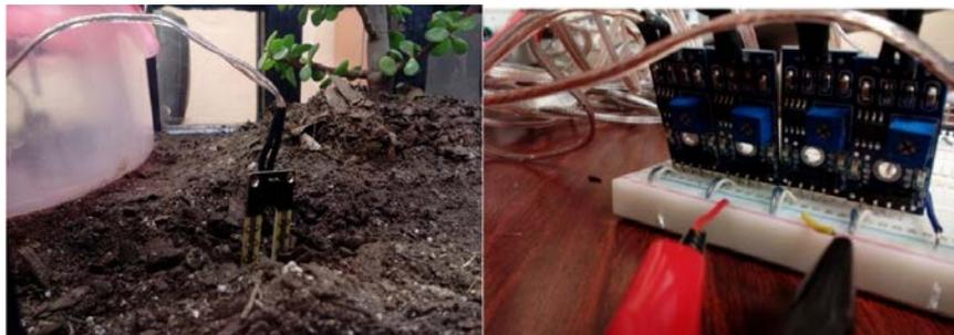
Figura 19 Sensor de humedad de tierra dentro del invernadero.
