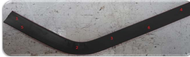
Figura 7 Puntos para la medición de la variación de espesor en las muestras de cable.
