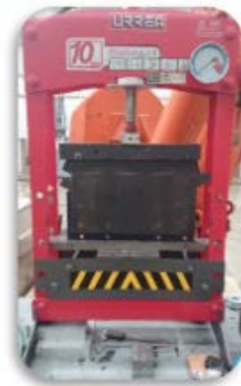
Figura 6 Prueba con la prensa mecánica, empleando los herramentales de nylamid.
