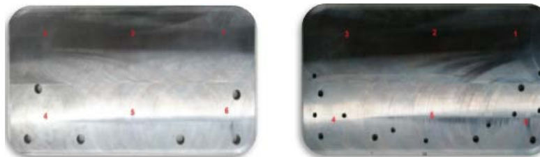
Figura 5 Puntos de medición de la rugosidad de las placas de acero del herramientales.
