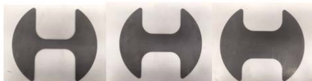
Figura 3 Probetas Nakazima de 25, 50 y 75 mm de 1.4 mm de espesor.
