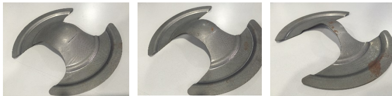
Figura 3 Probetas Nakazimas ensayadas.
