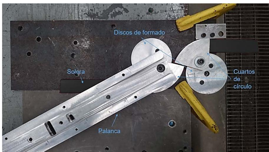
Figura 5 Componentes del mecanismo de rolado manual.
