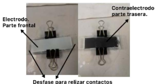
Figura 5 Vista frontal y transversal de una celda fotovoltaica ensamblada.
