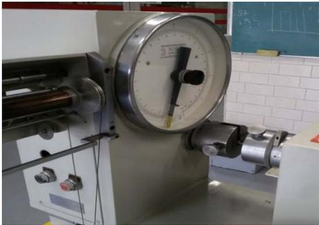
Figura 6a Máquina ensayos de torsión.
