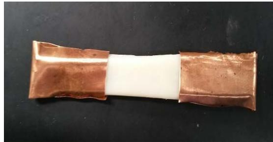
Figura 6b Probeta de hueso cortical.
