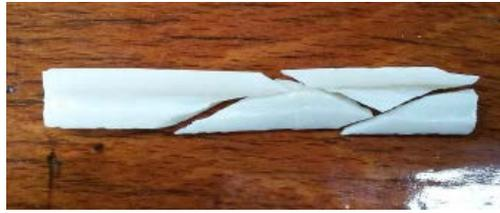
Figura 9 Probeta ensayada bajo cargas de torsión.
