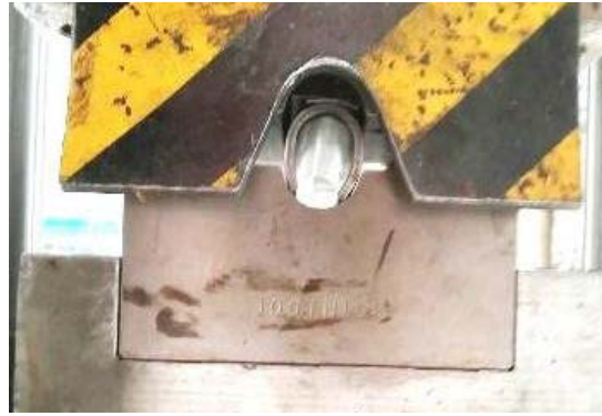
Figura 10 Dobleza en U (primer paso).
