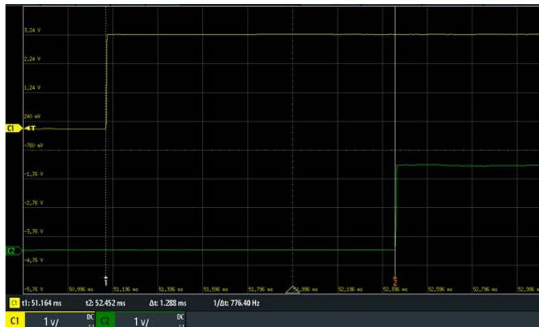
Figura 5 Medición de desfase entre señales sin ADPLL después 20 minutos de operación ( \Delta T=1.2 ms).
