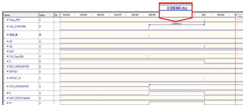
Figura 7 Desfase entre CLK Sync y Pulso PPS corresponde a \Delta T=1.6146 \times 10^{-5} segundos.
