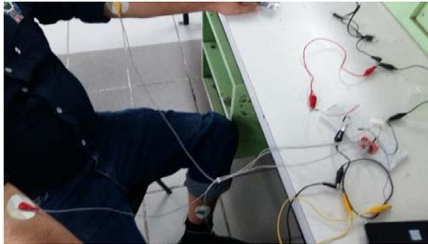
Figura 4 Lectura de pulsos ECG mediante los electrodos.
