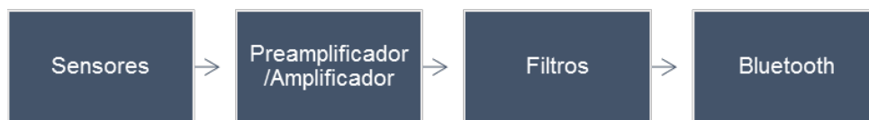
Figura 2 Diagrama de bloques del proceso de diseño electrónico.
