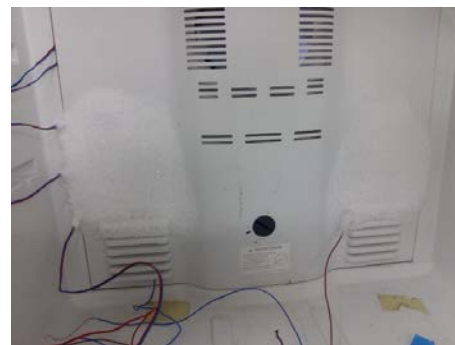
(b) Crecimiento de escarcha fuera del evaporador.
