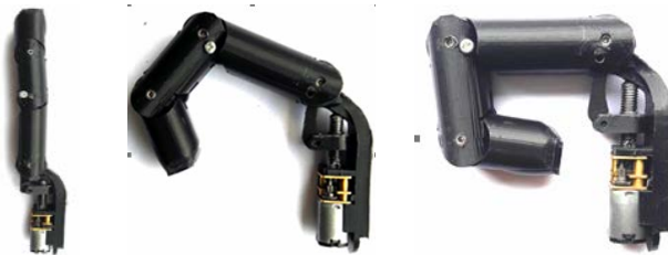
Figura 10 Dedo índice robótico multi-articulado antropométrico y antropomórfico.
