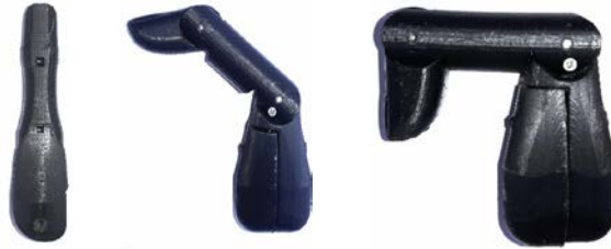
Figura 11 Dedo pulgar construido mediante impresión 3D.
